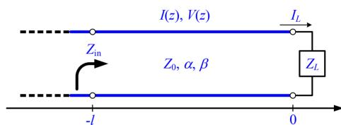
where  $\Gamma$ : reflection coefficient at load (=  $(Z_L - Z_0) / (Z_L + Z_0)$ ),
