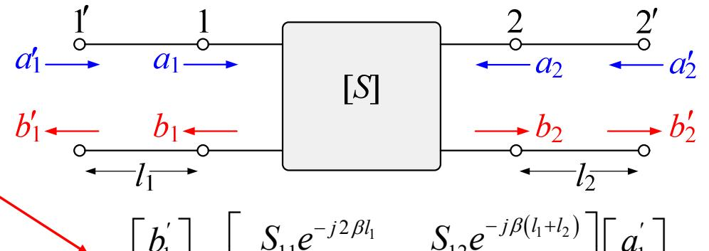
$$\begin{bmatrix} b'_1 \\ b'_2 \end{bmatrix} = \begin{bmatrix} S_{11} e^{-j2\beta l_1} & S_{12} e^{-j\beta(l_1+l_2)} \\ S_{21} e^{-j\beta(l_1+l_2)} & S_{22} e^{-j2\beta l_2} \end{bmatrix} \begin{bmatrix} a'_1 \\ a'_2 \end{bmatrix}$$
