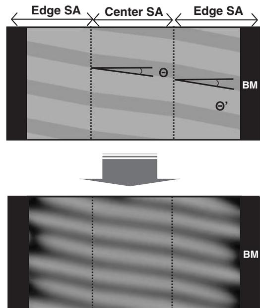
Edge Slit angle ( $\theta'$ ) > Center Slit angle ( $\theta$ )
