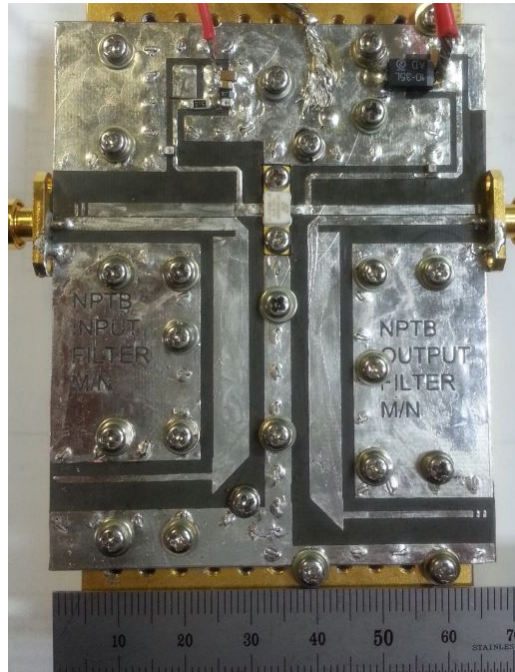
그림 5.6. 하모닉 차단 대역통과 정합회로를 사용한 전력증폭기 회로 .
