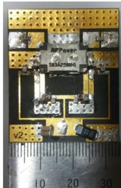
그림 4.9. 제작된 위상 천이기 버전 2의 사진.
