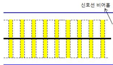
<그림 2> 양면형 가유전체 기판구조에서 신호선 비어홀을 통한 마이크로스트립 전송선로의 연결
