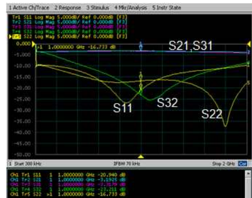
그림 7. 제작된 전력분배기의 측정된 S-파라미터 성능 Fig. 7. Measured S-parameters of the fabricated size-reduced power divider
